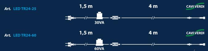
trasformartori 24V IP65 30 VA o 60VA (Watt) e cavo alimentazione 5,5m con: 1 connettore femmina IP44 \* \*Attenzione: i trasformatori sono compatibili con tutte le luminarie 24V prolungabili serie LED 24V TR1... per quasi tutte sarà sufficiente collegarle al connettore femmina IP44 LFA standard che trovate alla fine del cavo di alimentazione... per le restanti dovrete collegarle al connettore femmina IP44 KLD standard (rimuovendo prima l'adattatore avvitato al cavo di alimentazione)
