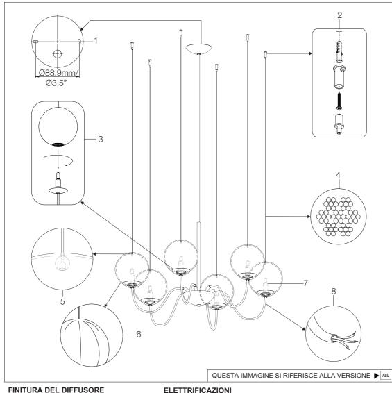
Rosone metallico con staffa a soffitto e quota di interasse fori di fissaggio.
