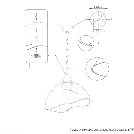
Interasse fori fissaggio a soffitto.
