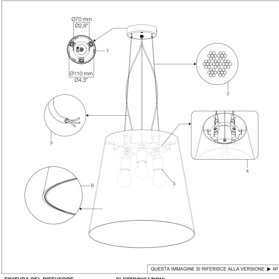
Rosone metallico con relative quote di interasse fori fissaggio a soffitto.
