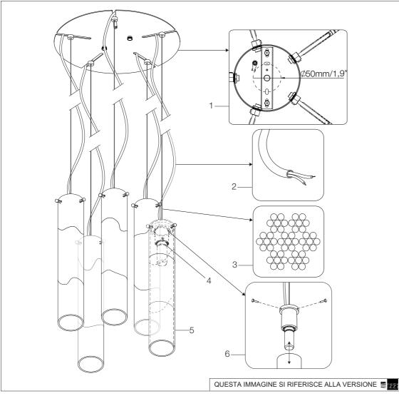
Montatura metallica con piastra di fissaggio a soffitto e relative quote di interasse fori.
