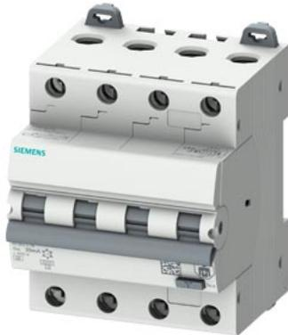
interruttore magnetotermico differenziale, 6 kA, 4P tipo A, 30 mA, car. C, In: 20A
