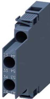
blocchetto di contatti ausiliari, laterale, 2 NO, a sinistra: 43/44, 53/54, a destra: 23/24, 33/34, via di corrente: 1 NO, 1 NO, morsetti a vite, per contattori 3RT2.1
