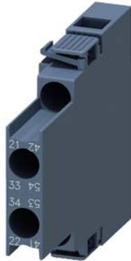
blocchetto di contatti ausiliari laterale, 1 NO + 1 NC via di corrente 1 NC, 1 NO per 3RH2 e 3RT2 morsetto a vite R: 21/22, 33/34 L: 41/42, 53/54
