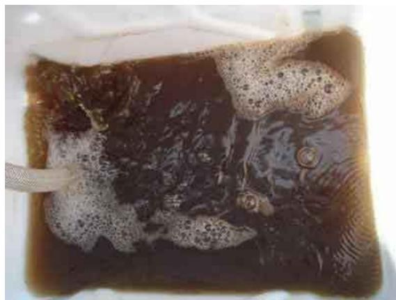
Lavare il serbatoio SolarFlush con l'acqua della rete idrica per eliminare eventuali depositi o fanghi.
