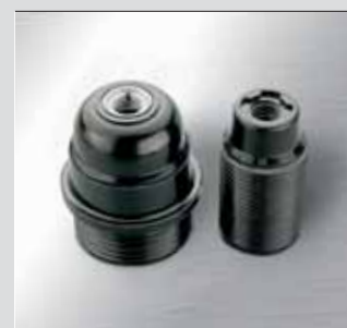
Portalampada in termoplastico: a sinistra con attacco E27 camicia liscia e nippel in metallo; a destra con attacco E14, camicia filettata e con filetto stampato.
