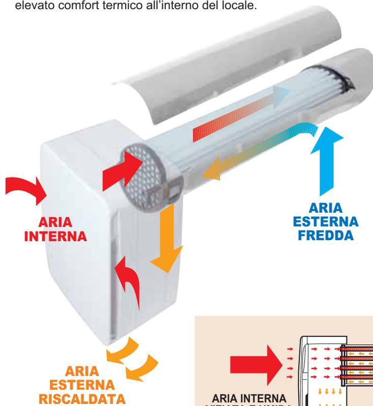
L'aria pulita, proveniente dall'esterno, viene riscaldata da quella viziata in uscita tramite una particolare tubazione che andrà inserita all'interno di un semplice foro a parete diametro mm. 100, rendendo V-ECO100 particolarmente idoneo per la sostituzione degli aspiratori tradizionali. Può essere installato su tutti i muri utilizzando un foro già esistente senza lavori aggiuntivi di muratura o imbiancatura.
