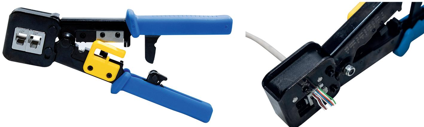
Pinza crimpatrice modulare, consente una facile installazione dei connettori CAT5e FTP, CAT5e UTP, CAT6 FTP e CAT6 UTP RJ11, RJ12, RJ45 PLUG 6/8P, anche con cavo passante (pass through) ed incorpora un cutter ed uno spela fili, per avere uno strumento completo per la realizzazione dei cavi di rete.
