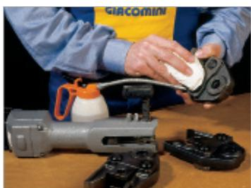
Per un corretto e duraturo funzionamento della pressatrice è importante rispettare le scadenze della revisioni programmate e le pinze devono essere sempre perfettamente pulite ed oliate, per evitare sforzi anomali nella pressatura che possano ridurre la durata dei meccanismi.
