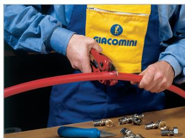
Tagliare il tubo perpendicolarmente al proprio asse, utilizzando la cesoia R990M, (si consiglia di ruotare leggermente la cesoia durante l'operazione), oppure la tagliatubi a rotella RP204, al fine di limitare l'ovalizzazione del tubo stesso.
