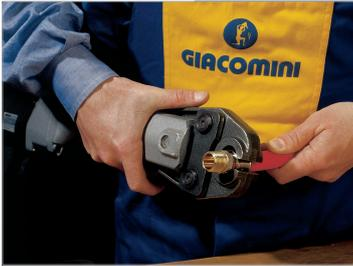
Per la pressatura dei raccordi utilizzare una ganaschia della misura corrispondente a quella del raccordo e con profilo secondo la tabella 1:
