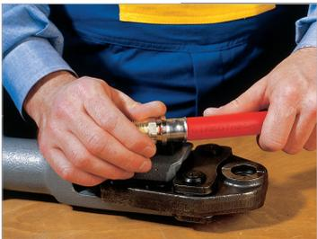
Verificare il corretto serraggio ed in particolare, osservando l'anello ferma bussola, la corretta posizione del tubo. I raccordi sono a chiusura irreversibile, nel caso di pressature non corrette è inevitabile il taglio del tubo ed il rifacimento della giunzione con nuovo raccordo.
