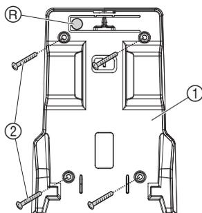
Il distributore d'acqua può essere montato sul pavimento o sul muro (entrata in alto) per mezzo della piastra di fissaggio ①.
