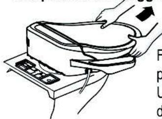
Far slittare il sedile sulla piastra di fissaggio. Un "Click" indica che il dispositivo è posizionato correttamente.
