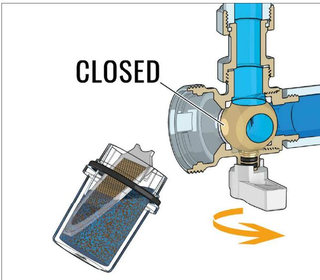
La particolare conformazione della valvola di intercettazione consente di effettuare la pulizia degli elementi interni scaricando la sola acqua contenuta nel filtro.
