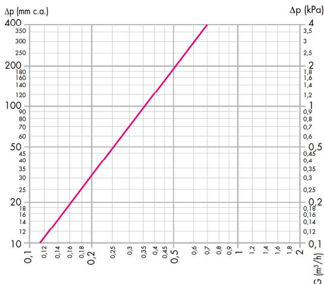
**Kv (con filtro pulito): 3,55 m<sup>3</sup>/h**
