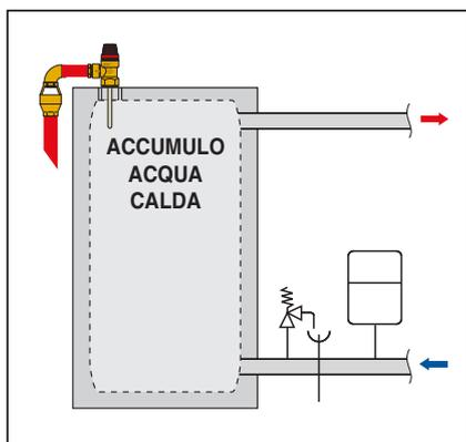
Prestare attenzione affinché non ci sia interposizione di alcun dispositivo di intercettazione tra la valvola e l'accumulo. Le valvole di sicurezza TP possono essere montate in posizione verticale od orizzontale, non capovolte.
