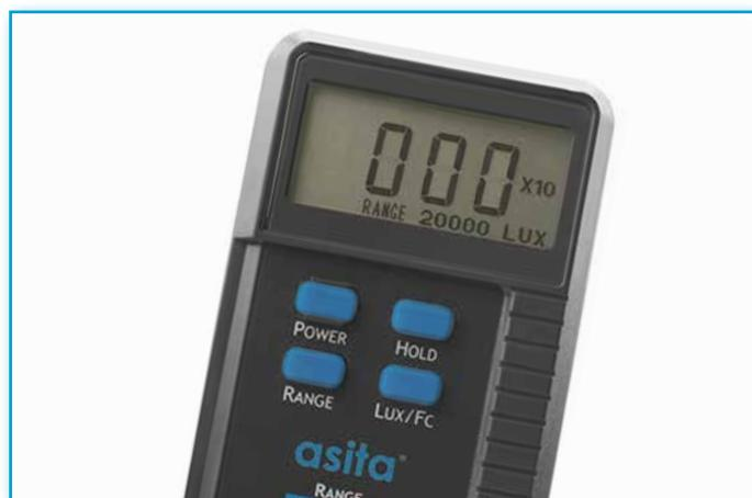
LX350 è un luxmetro digitale palmare per la misura dell'illuminamento tramite sensore semisferico fotodiode al silicio, per valori fino a 20000lux su 3 portate di misura. Il modulo del sensore è collegato al modulo indicatore digitale tramite cavo spiralato estensibile per consentire di eseguire le prove senza influenzare le misure a causa di ombreggiamenti e similari.
